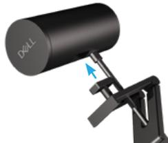
3. Abra la base de montaje de la webcam y sujétela junto con la webcam en el bisel del monitor.
