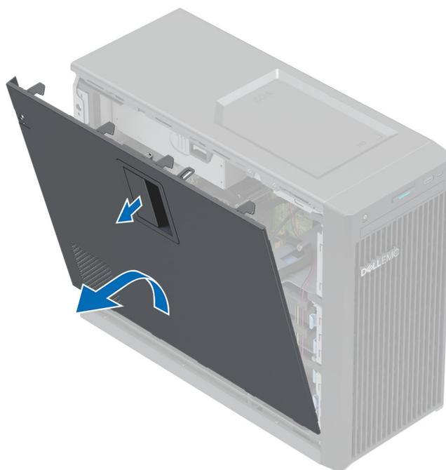
**Ilustración 8. Extracción de la cubierta del sistema**
