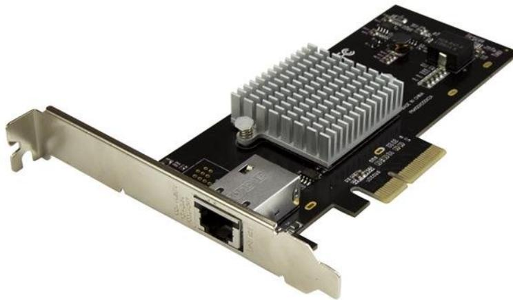
He aquí una solución potente y que resulta económica a la hora de actualizar su servidor o estación de trabajo a red Ethernet de 10 Gigabits a través de cobre. Esta tarjeta NIC PCI Express 10G le permite agregar un puerto Ethernet a su servidor o computadora de escritorio y acceder a su red a varias velocidades: 10G, 5G, 2,5G, 1G y 100Mbps.
