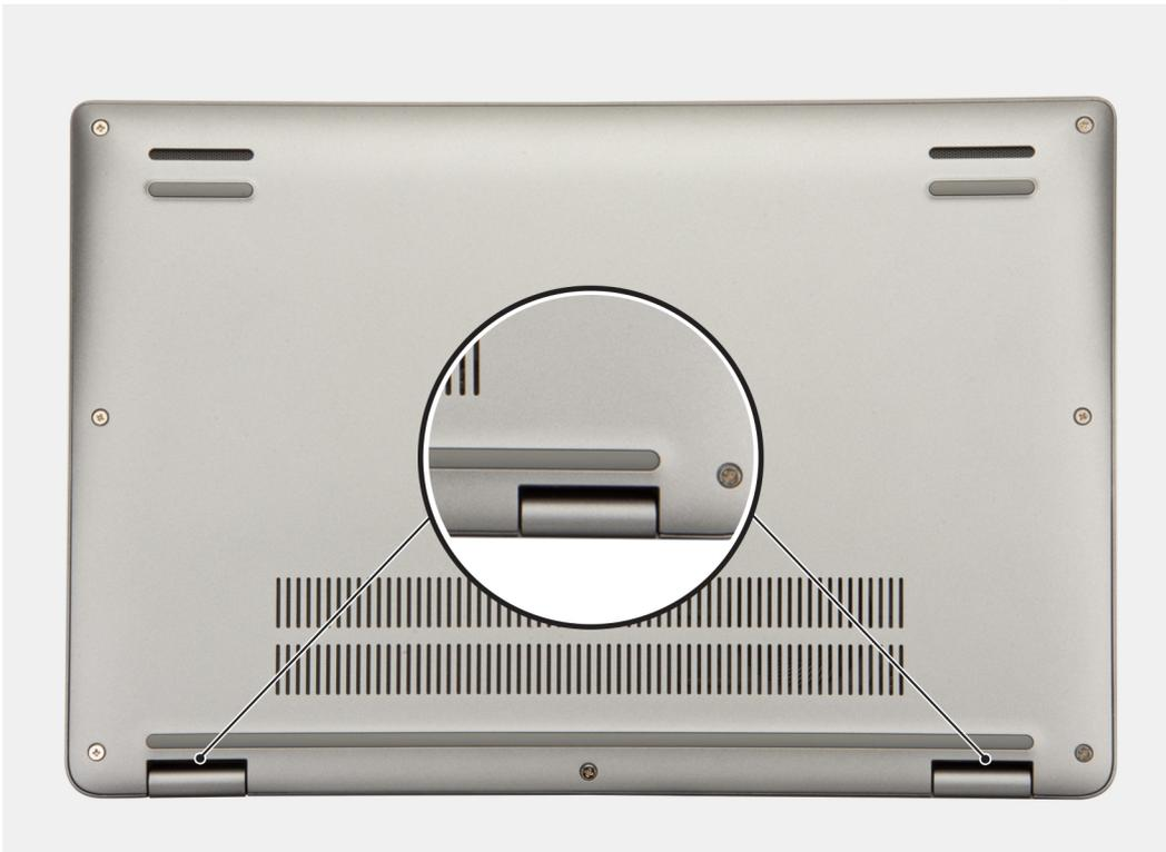
3. Haga palanca para abrir la parte superior de la cubierta de la base y continúe trabajando en los lados izquierdo y derecho para abrir la cubierta de la base.
