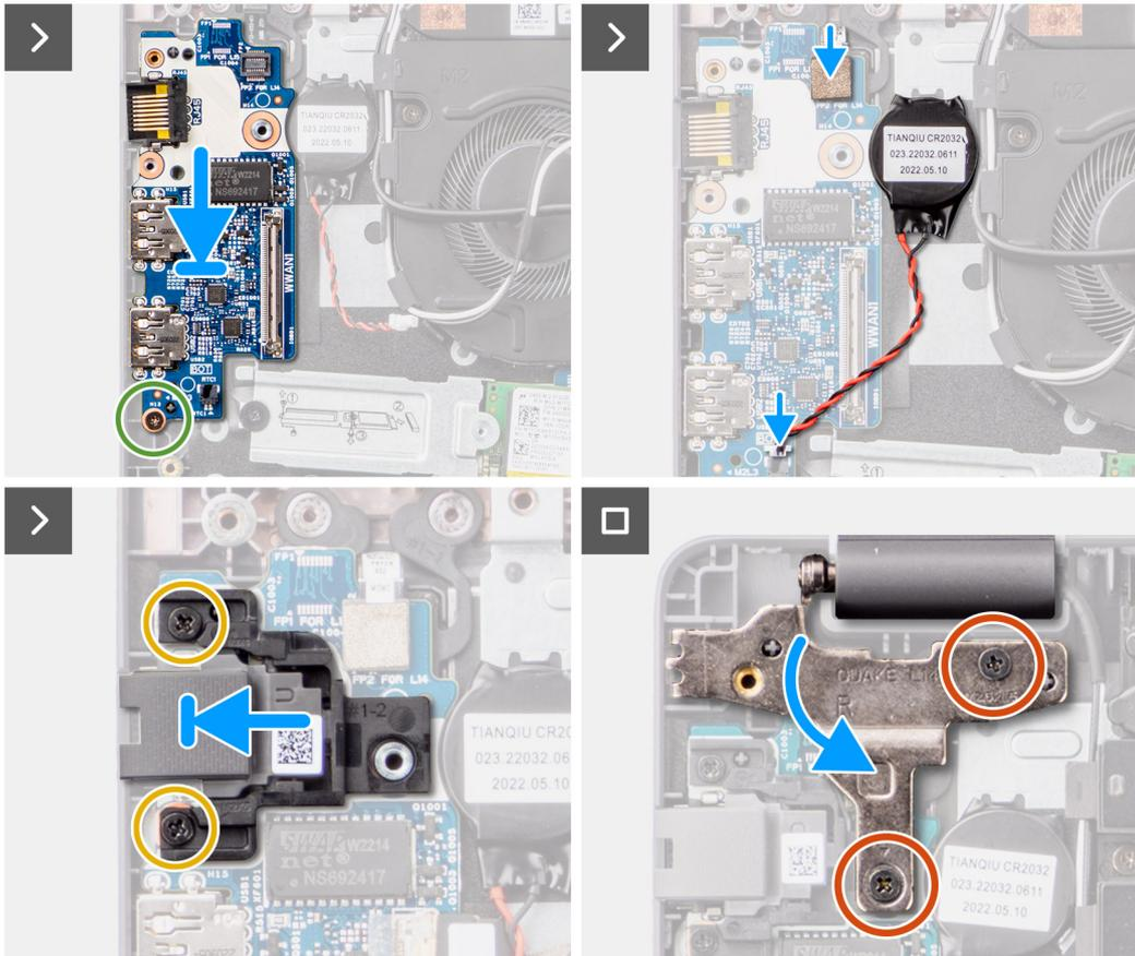
**PRECAUCIÓN:** El sistema tiene una batería de tipo botón que se conecta a la placa de I/O. Desconectar el cable de la placa de I/O restablece los ajustes del programa de configuración del BIOS a los predeterminados. Tenga en cuenta los ajustes del programa de configuración del BIOS antes de desconectar el cable de la placa de I/O.
