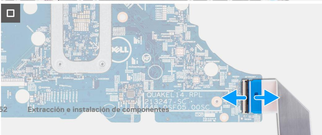
**PRECAUCIÓN:** El sistema tiene una batería de tipo botón que se conecta a la placa de I/O. Desconectar el cable de la placa de I/O restablece los ajustes del programa de configuración del BIOS a los predeterminados. Tenga en cuenta los ajustes del programa de configuración del BIOS antes de desconectar el cable de la placa de I/O.
