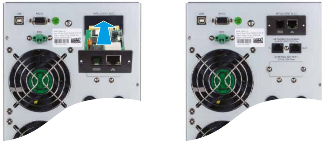
**Paso 3:** Conecte un cable de ethernet suministrado por el usuario en el puerto de ethernet (RJ-45) del administrador web SNMP.
