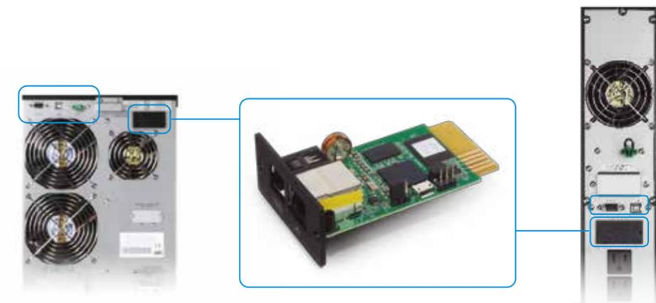
**Paso 2:** Inserte la tarjeta con cuidado en la ranura y luego fíjela con los tornillos que quitó en el paso 1.
