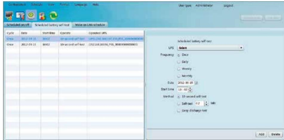
1. Seleccione el método así como los parámetros de tiempo. La unidad dispone de tres tipos de verificación automática para la batería:
