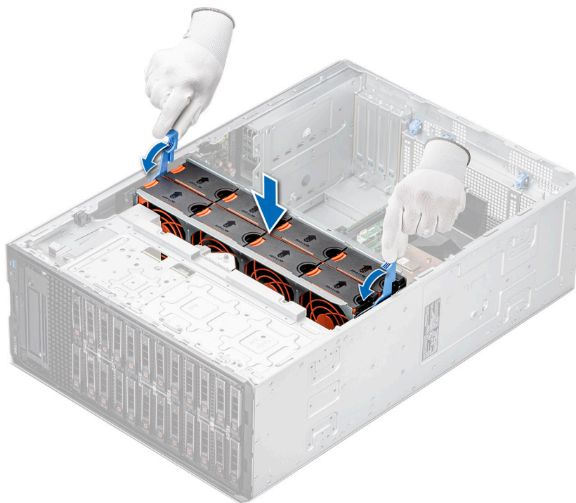
Ilustración 38. Instalación del compartimento del ventilador de refrigeración
