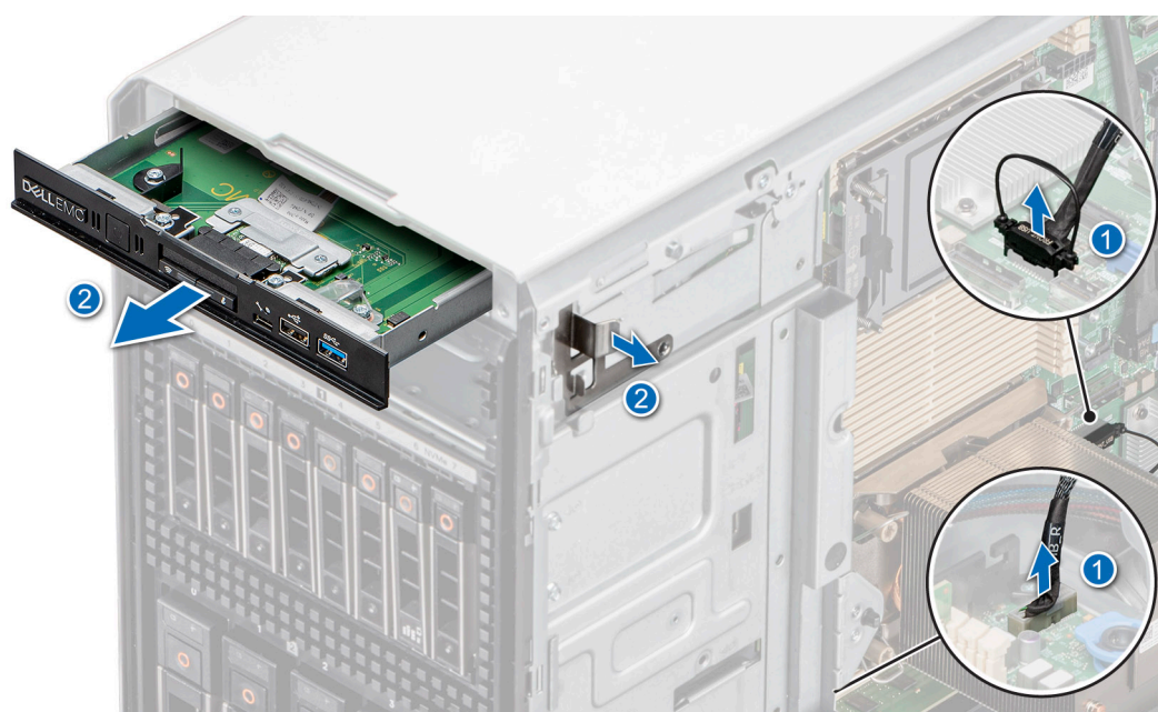
Ilustración 102. Extracción del módulo de I/O frontal para la configuración de gama superior
