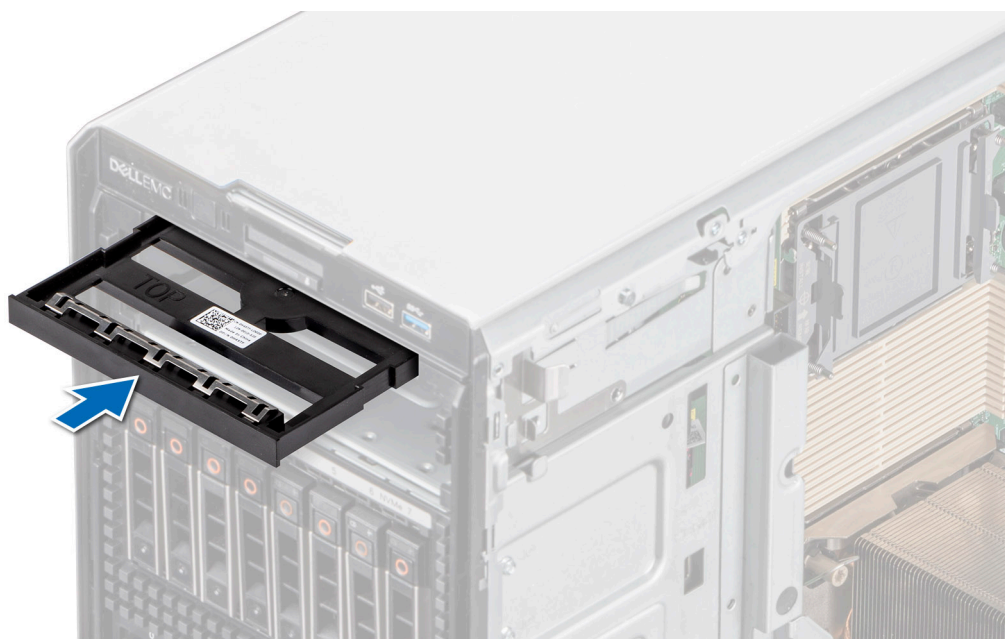
Ilustración 94. Instalación de la unidad óptica de relleno
