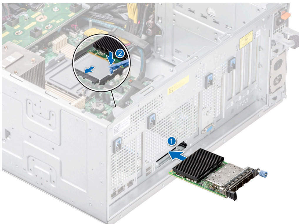
Ilustración 155. Instalación de la tarjeta OCP
