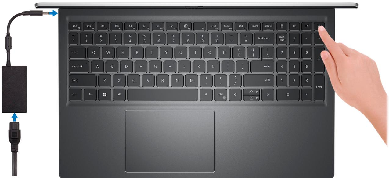
**NOTA:** Para conservar la energía de la batería, es posible que esta entre en el modo de ahorro de energía. Para encender el equipo, conecte el adaptador de alimentación y presione el botón de encendido.
