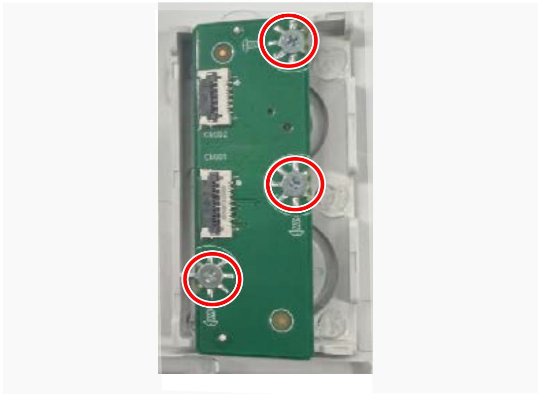
Figura 42. Instalar la placa del teclado
