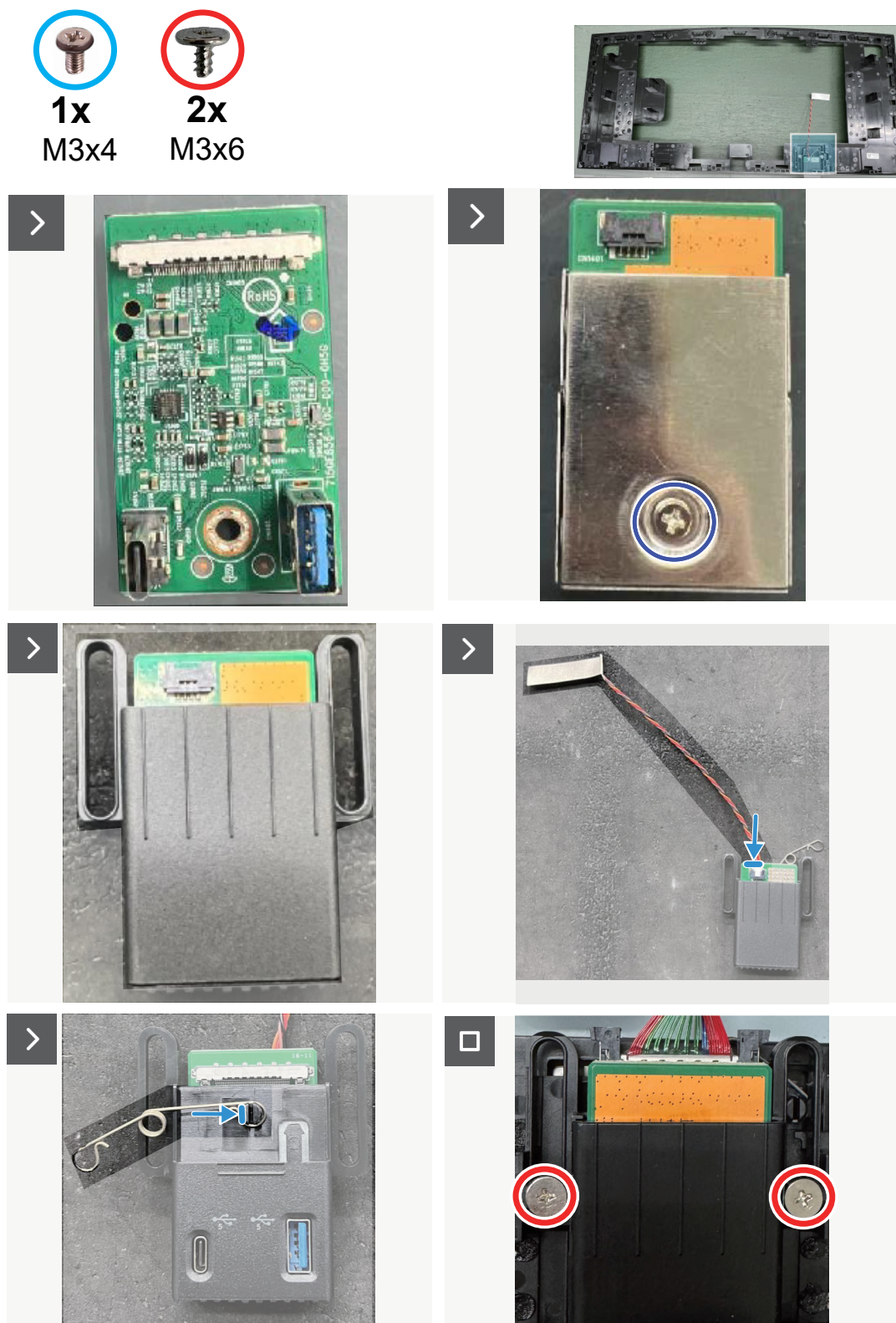
Figura 40. Instalar la placa USB
