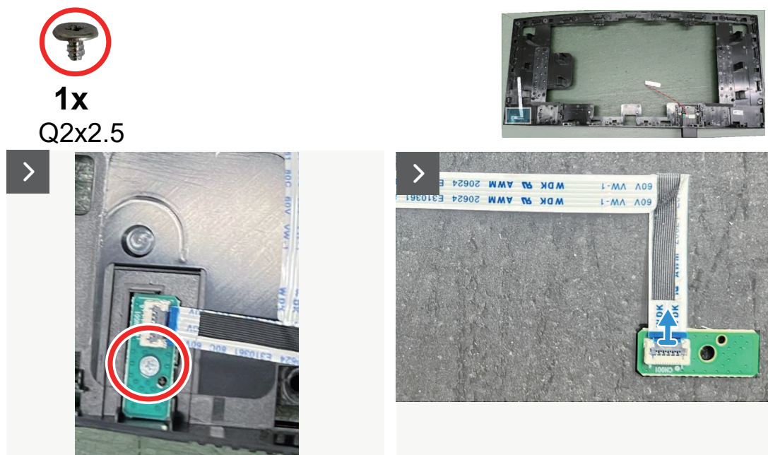
Figura 37. Retirar la placa Lens
