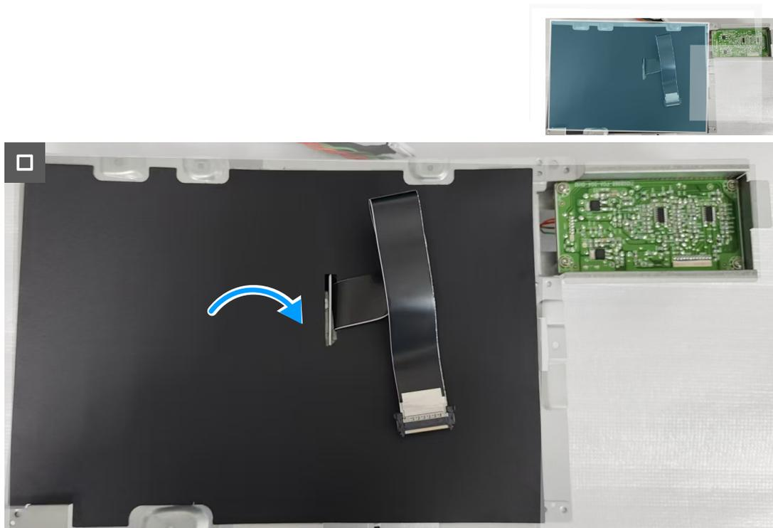
**Figura 22. Instalar la cinta Mylar**
