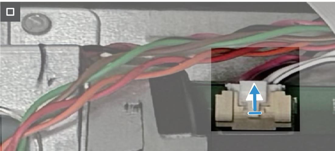
**Figura 8. Retirar los tornillos y desconectar el cable del altavoz**
