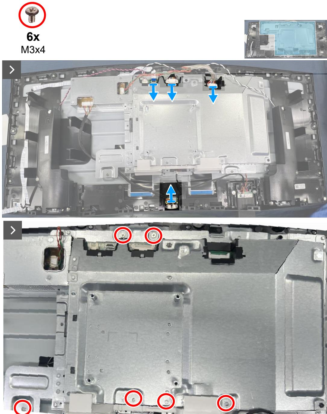
**Figura 11.** Desconectar los cables y retire los tornillos
