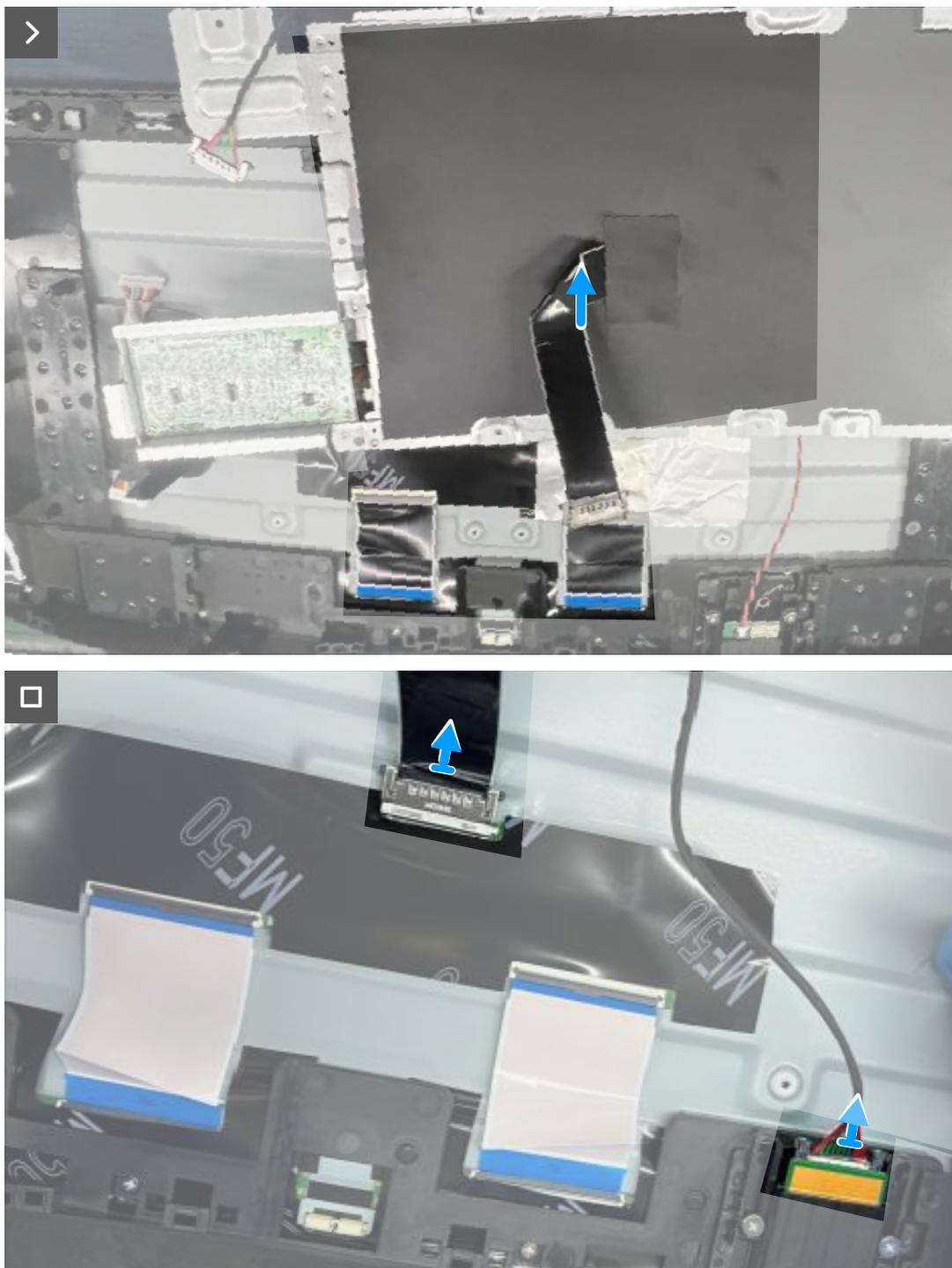
**Figura 12. Desconectar los cables de la pantalla**
