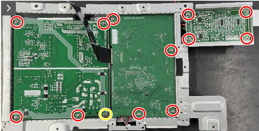
**Figura 20.** Volver a colocar los tornillos
