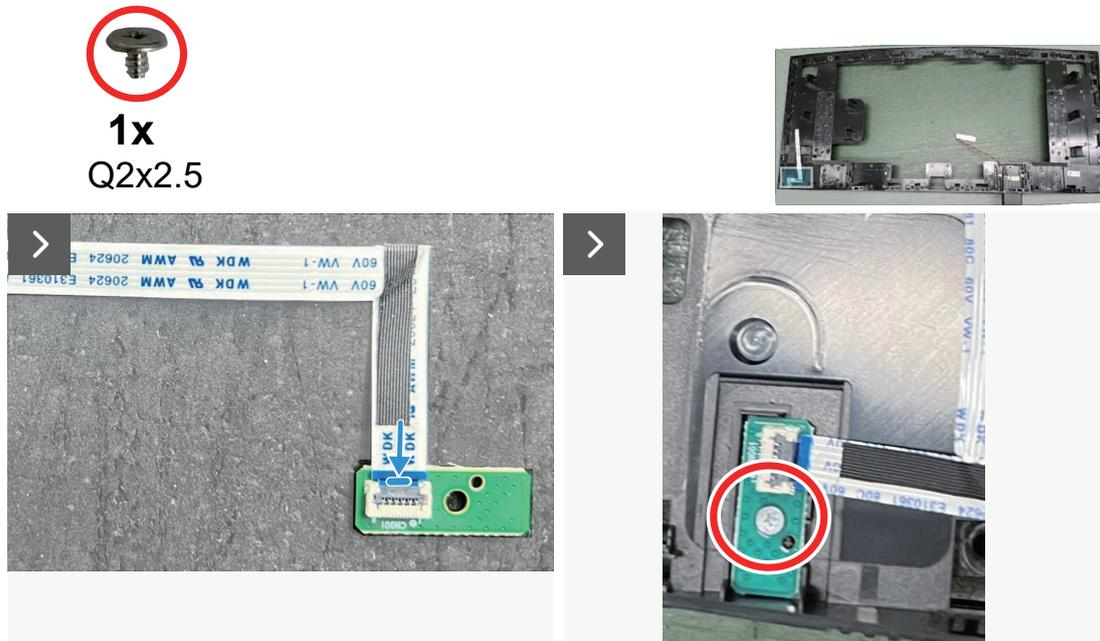
Figura 26. Instalar la placa Lens
