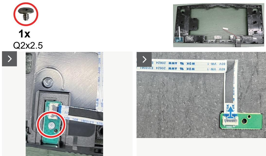
**Figura 25. Retirar la placa Lens**
