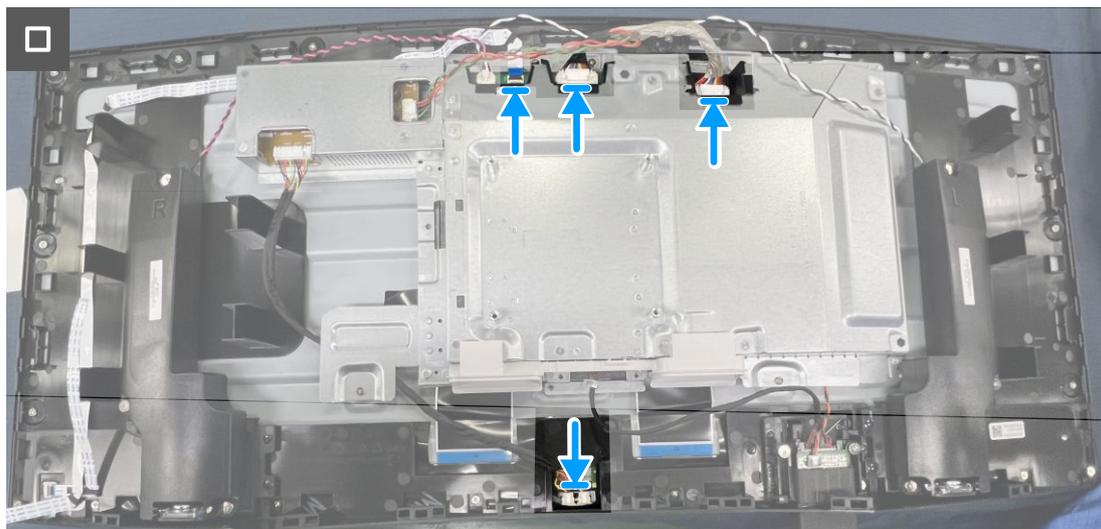
**Figura 14. Volver a colocar los tornillos y desconectar de los cables**
