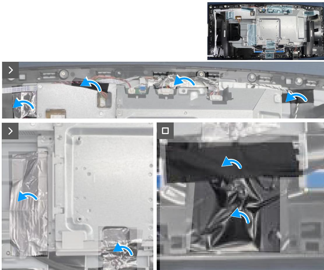
**Figura 10. Pegar las cintas para fijar los cables y la protección metálica**
