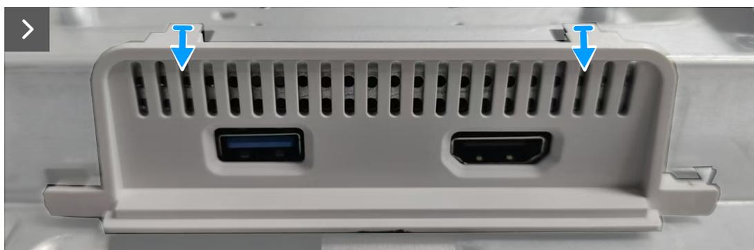
**Figura 16.** Retirar la cubierta de E/S de la protección metálica
