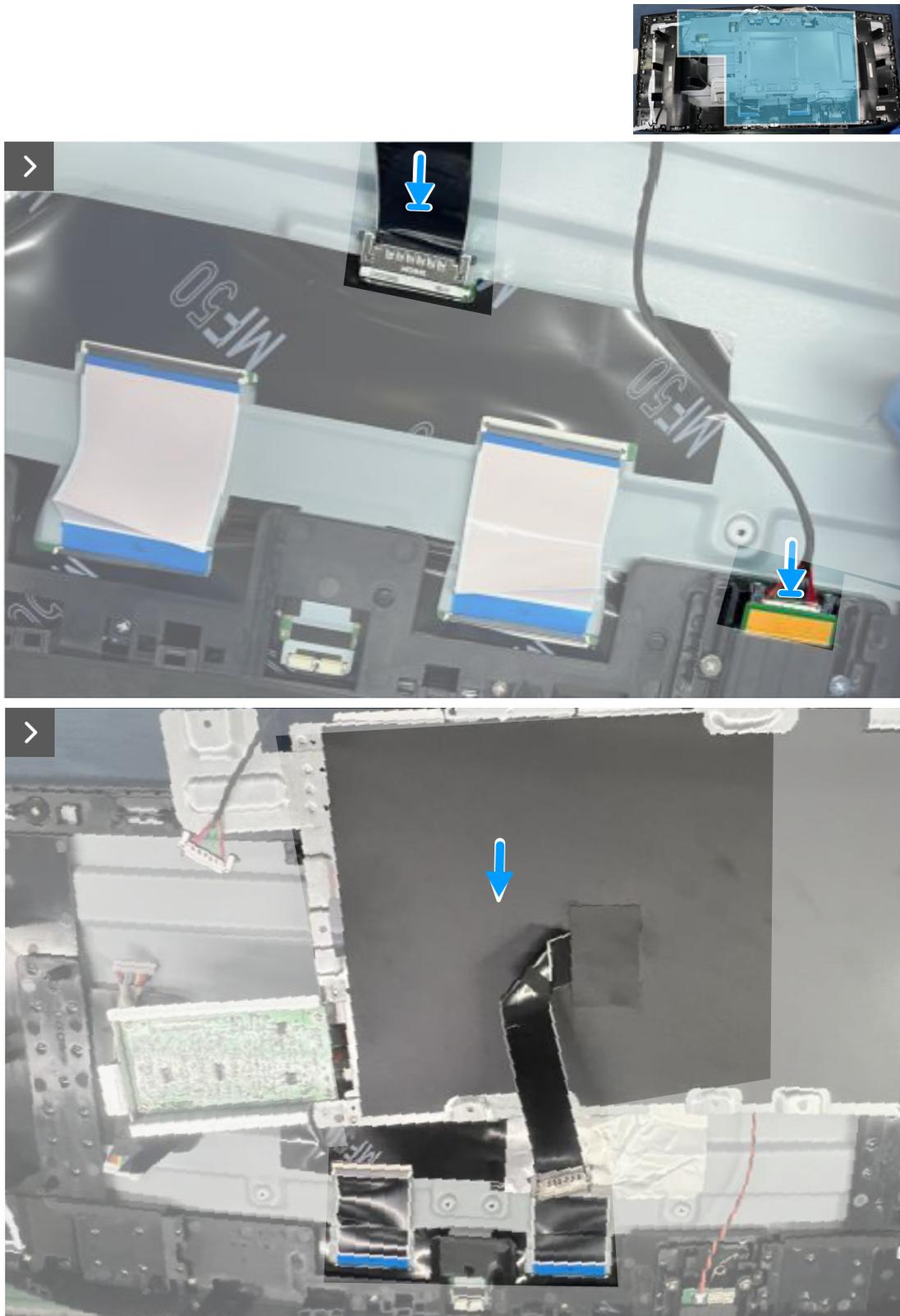
**Figura 13.** Conectar los cables de la pantalla
