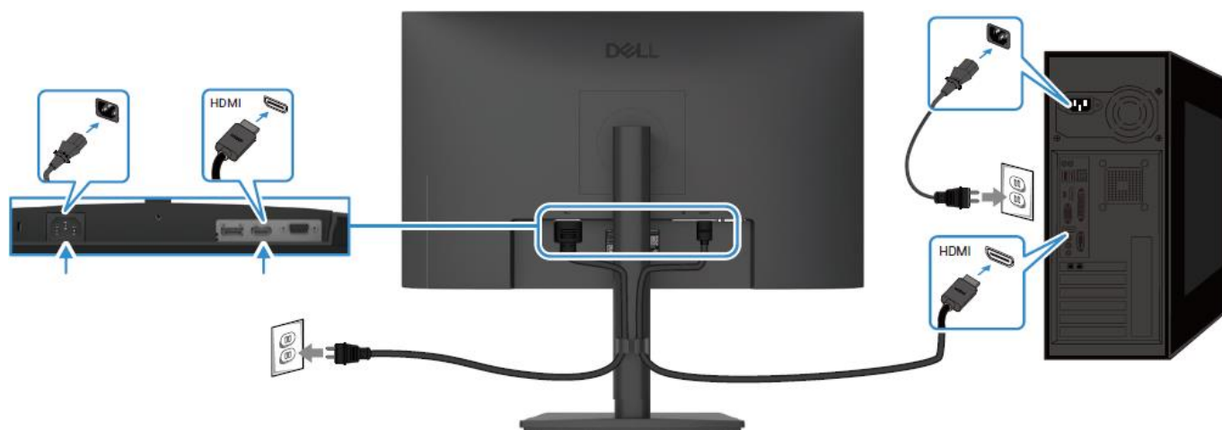
Imagen 9. Conexión del cable HDMI
