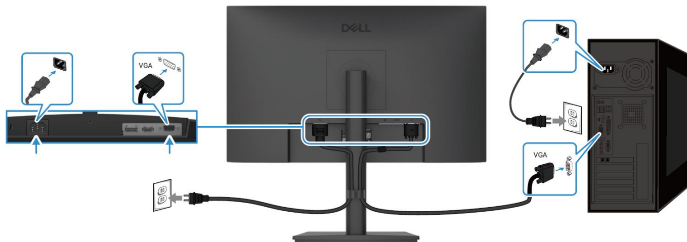
Imagen 7. Conexión del cable VGA
