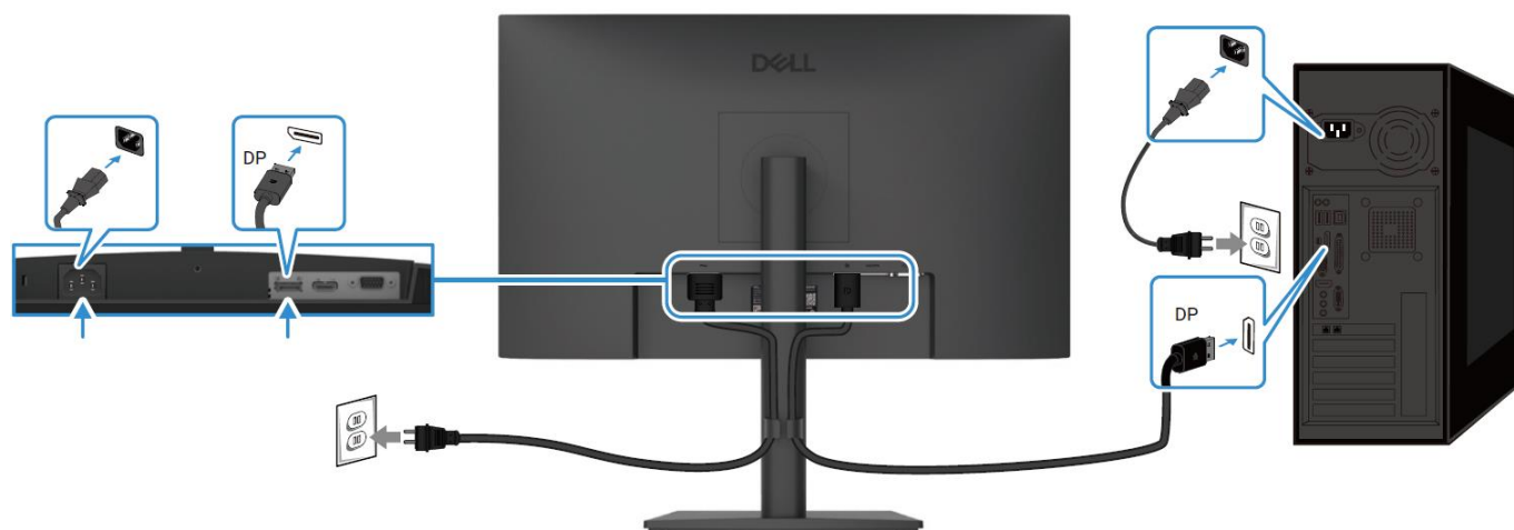
Imagen 8. Conexión del cable DP
