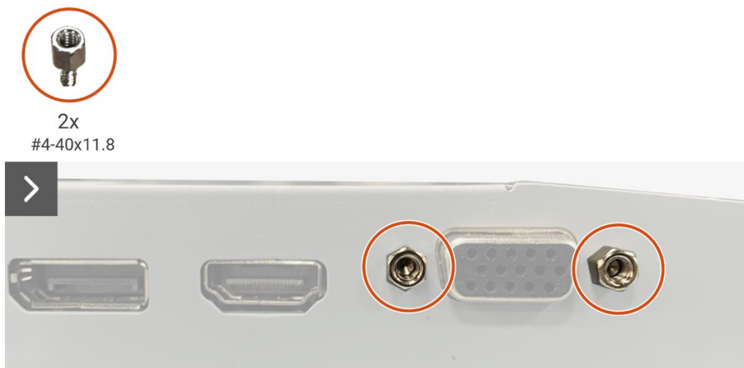
Imagen 24. Extracción de la placa de la interfaz
