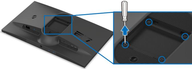
**NOTA:** Utilice tornillos de M4 x 10 mm para conectar el monitor al kit de montaje en pared.
