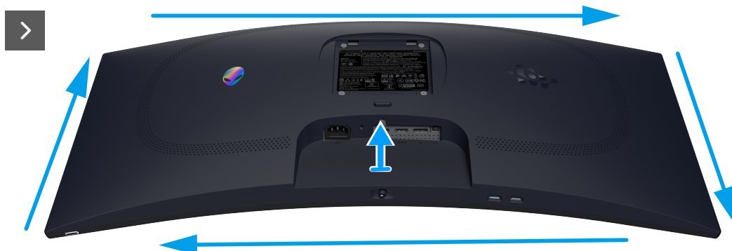
Figura 14. Quitar la cubierta posterior
