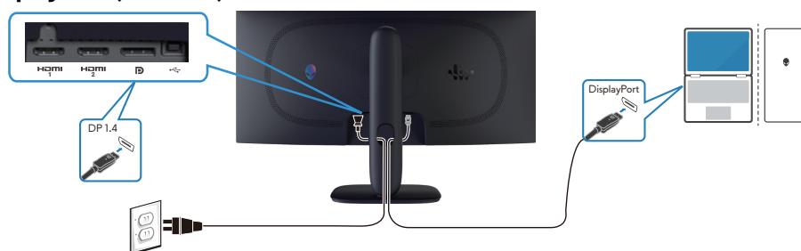
Figura 8. Conectar el cable DisplayPort (DP a DP)
