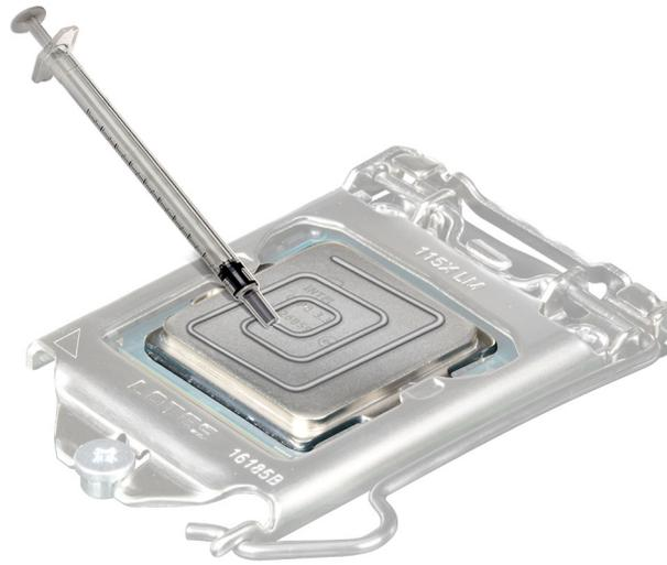
**Ilustración 47. Aplicación de la grasa térmica**
