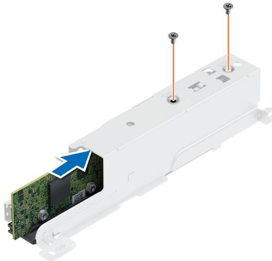
**Ilustración 58. Instalación de la tarjeta BOSS N1**
