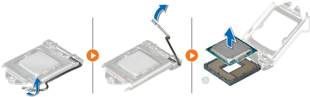
**Ilustración 45. Extracción del procesador**
