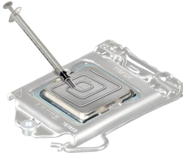
**Ilustración 48. Aplicación de la grasa térmica**
