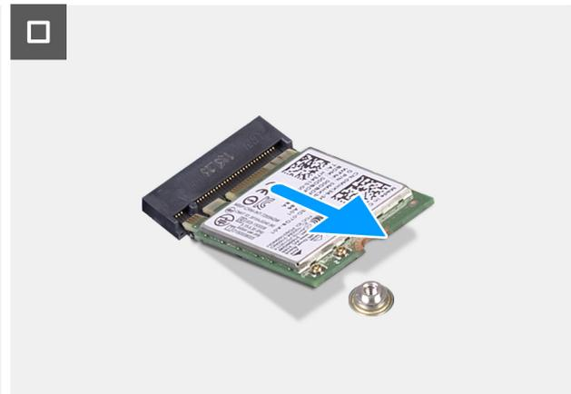
Ilustración 21. Extracción de la tarjeta inalámbrica
