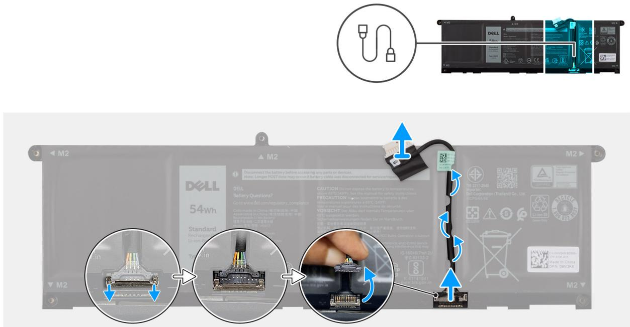
**Ilustración 27. Desconexión del cable de la batería**
