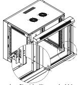
6 Verwenden Sie 4 beiliegende M6-Schrauben (6 für größere Schränke), um den Frontrahmen (2) an der Konstruktion zu befestigen.
