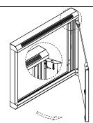
Öffnen Sie die Tür (1) mit dem beiliegenden Schlüssel und nehmen Sie sie vom Frontrahmen (2) ab, indem Sie den Scharnierstift nach unten drücken.
