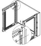
Verwenden Sie 4 beiliegende M6-Schrauben (6 für größere Schränke), um die beiden Seitenrahmen (3) jeweils am rückseitigen Rahmen (6) zu befestigen.
