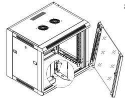
Setzen Sie die Tür (1) aus Schritt 2 wieder ein, indem Sie den unteren Scharnierstift unten im Rahmen platzieren und den oberen an der Oberseite einsetzen. Hinweis: Sobald der Schrank montiert ist, prüfen Sie, dass alle Ecken genau rechtwinklig verbaut sind, damit die Tür ordnungsgemäß geöffnet und geschlossen werden kann.
