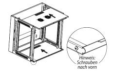
Schieben Sie die Oberseite (5) und die Bodenplatte (8) in Position.
