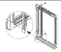
Verwenden Sie 4 beiliegende M5-Schrauben, um eine Montageschiene (7) an jedem Seitenrahmen (3) zu befestigen.
