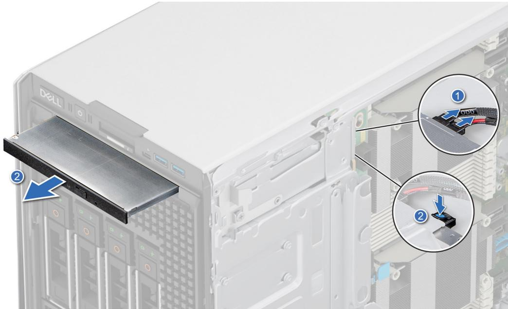
**Ilustración 127. Extracción de la unidad óptica**
