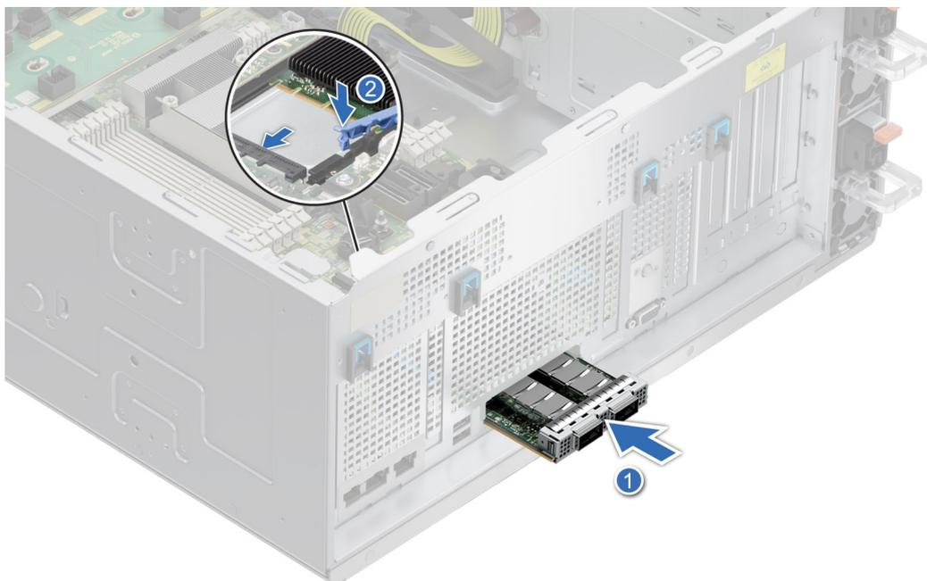
**Ilustración 176. Instalación de la tarjeta OCP**
