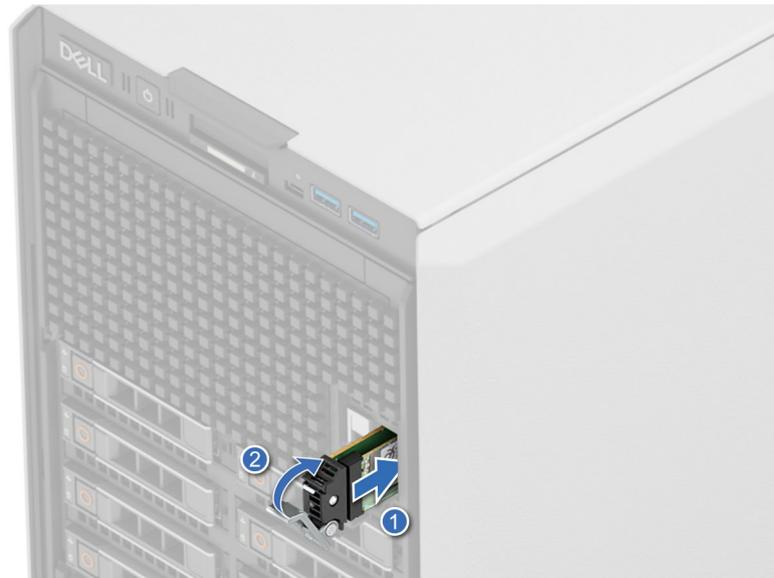
**Ilustración 147. Instalación del portatajetas de tarjeta BOSS-N1**
