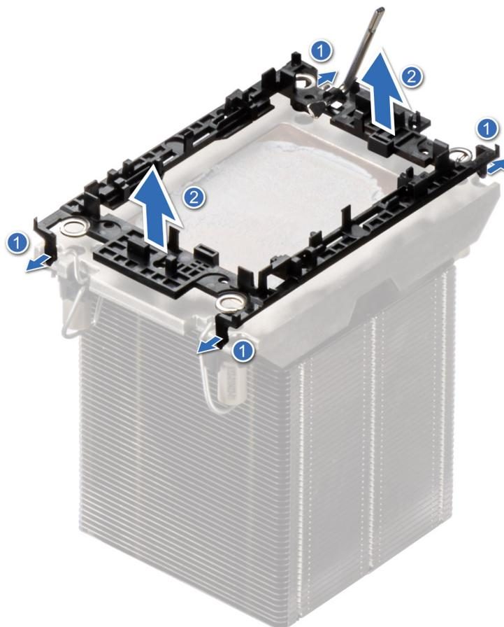
**Ilustración 164. Extracción del gancho de retención**
