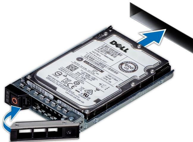
**Ilustración 103. Instalación de un portaunidades**
