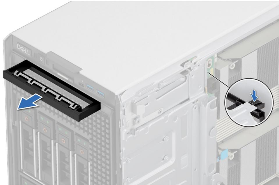
**Ilustración 125. Extracción de la unidad óptica de relleno**
