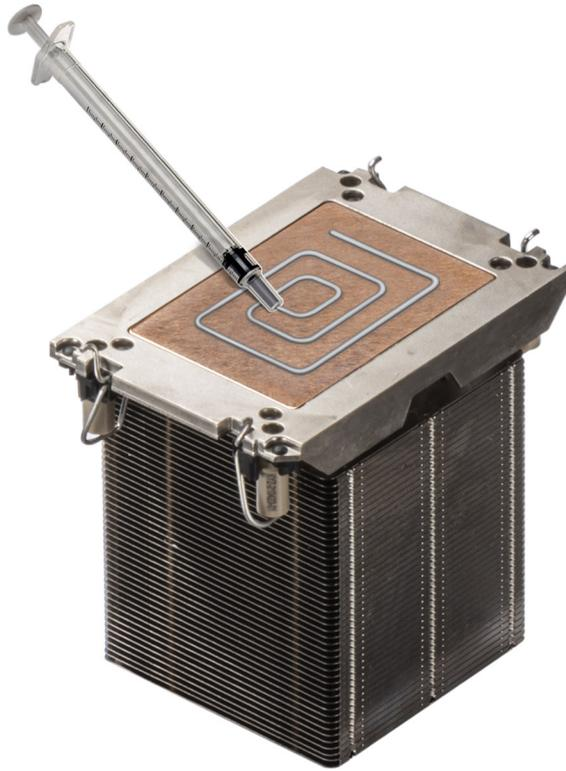
**Ilustración 167. Aplicación de la grasa térmica**
