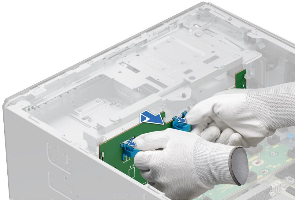
**Ilustración 109. Extracción del backplane de unidades de 3,5 pulgadas**
