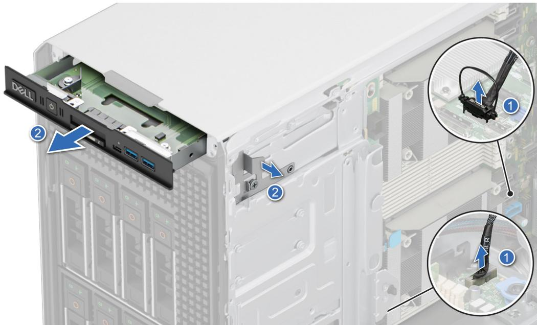
**Ilustración 133. Extracción del módulo de I/O frontal**
