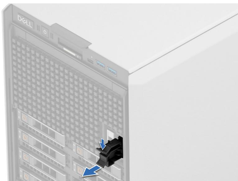
**Ilustración 198. Extracción del módulo de BOSS-N1 de relleno**
