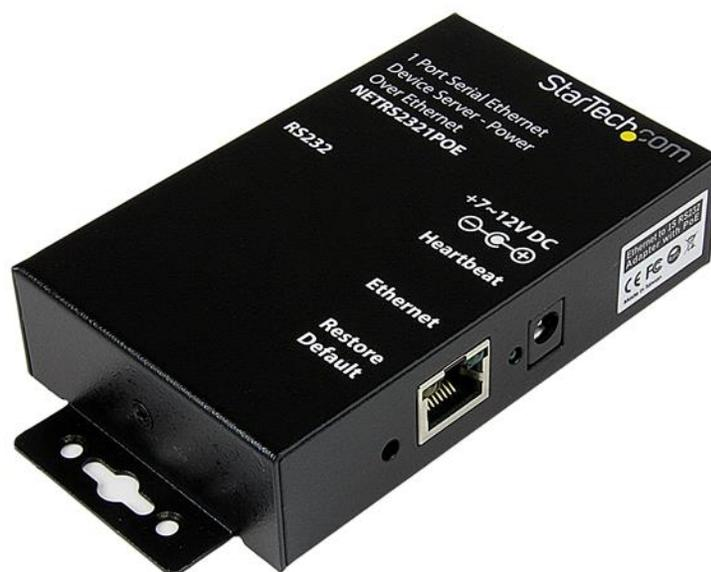
El Servidor de Dispositivo Ethernet de 1 puerto serial RS232 – PoE (Alimentación a través de Ethernet, NETRS2321POE permite instalar sus dispositivos RS232 en cualquier lugar de su red WAN/LAN TCP/IP Ethernet, y acceder a ellos como si se encontraran a su lado. ¡También puede acceder por Internet!
