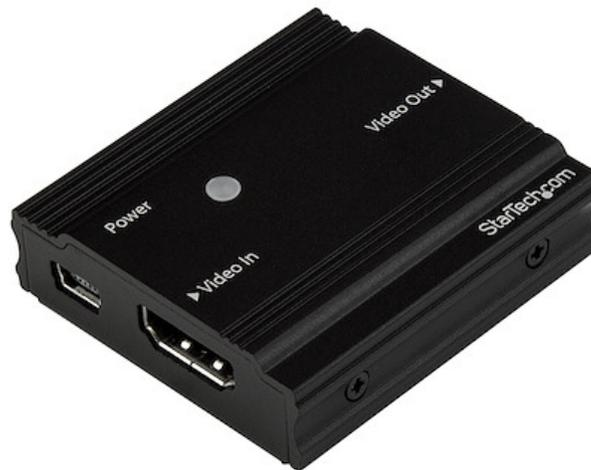
Este amplificador de señal HDMI® 4K le permite aumentar la intensidad de la señal de su fuente de video HDMI para que pueda recorrer mayores distancias utilizando cables HDMI estándar. Puede conseguir resoluciones de hasta 4K a 60 Hz a distancias de hasta 10m, y dependiendo de la resolución que desee, el amplificador admite distancias de hasta 35 m con una resolución de 1080p a 60 Hz.
