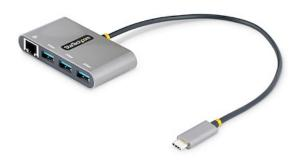
Este Hub USB-C con Ethernet Gigabit añade tres puertos USB-A 3.2 Gen 1 (5Gbps) y un puerto Ethernet Gigabit a una computadora con USB-C. El hub USB alimentado por bus se conecta a un puerto USB-C de una laptop, utilizando el cable anfitrión de 30cm incorporado. Este hub USB es de tamaño compacto, lo que facilita su portabilidad cuando se viaja.
