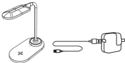
2. Coloca tu dispositivo móvil en el área de carga asegurándote de que la posición del receptor de carga coincida de manera correcta con el cargador de lámpara
